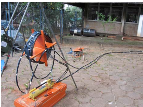
Figura 1 - Ensaio crosshole , mostrando em primeiro plano a fonte de ondas S inserida no furo.
