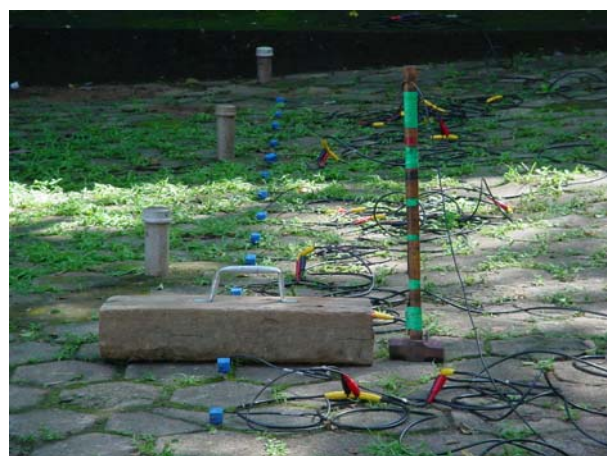
Figura 3 - Levantamento de refração sísmica para geração e captação de onda S, realizado nas proximidades dos furos do ensaio crosshole .
