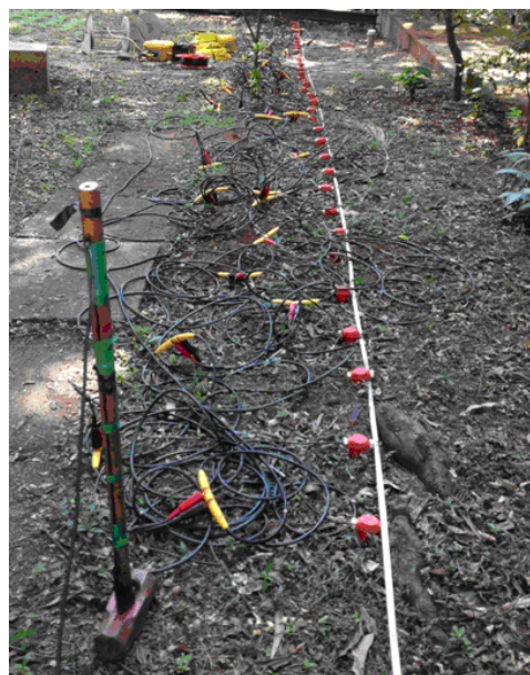
Figura 2 - Levantamento MASW, realizado em um alinhamento perpendicular à direção dos furos do ensaio crosshole .
